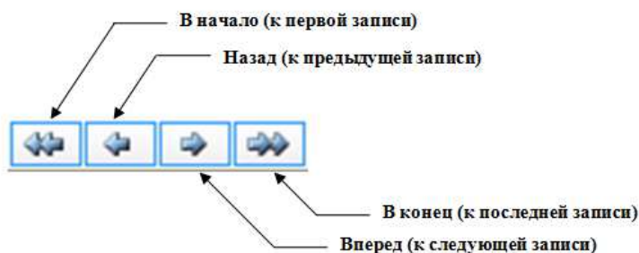
Рисунок 11 – Назначение кнопок навигатора
